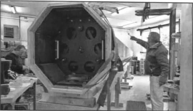
Abb. 13: Tubus streichen und Einpassen der Spiegelzelle am 1. September 2015. Foto: H.-J. LEUE
