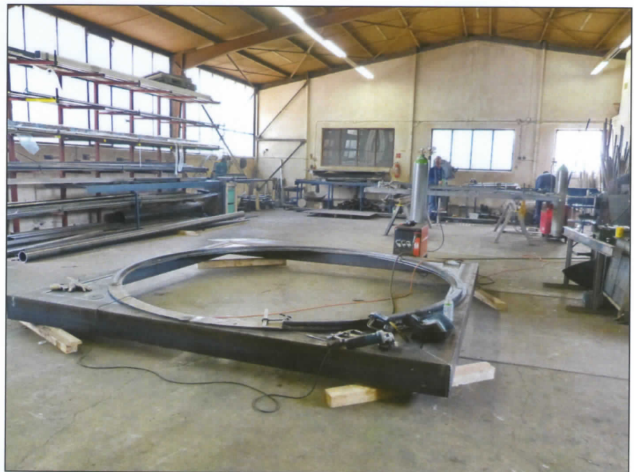
Abb. 4: Der Drehkranz für die Plattform.
