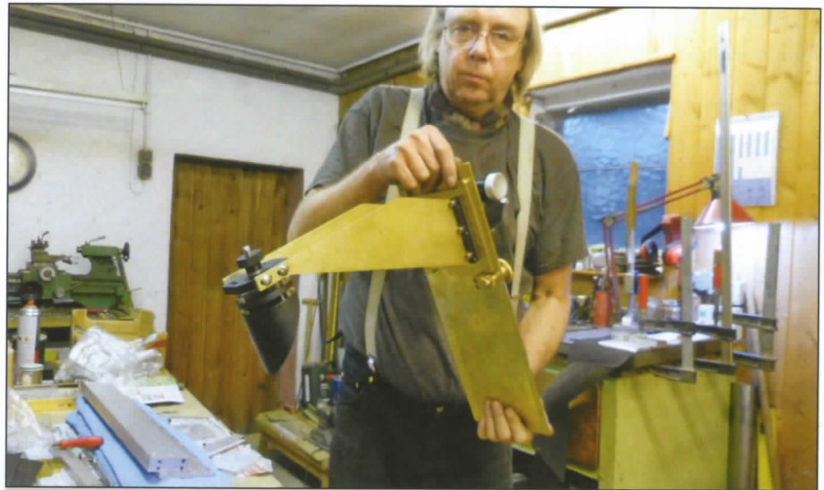
Abb. 3: Okularauszug mit Fangspiegelhalterung.
